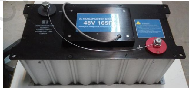
شکل ۹: ابر خازن ۴۸ ولت، ۱۶۵ فاراد
